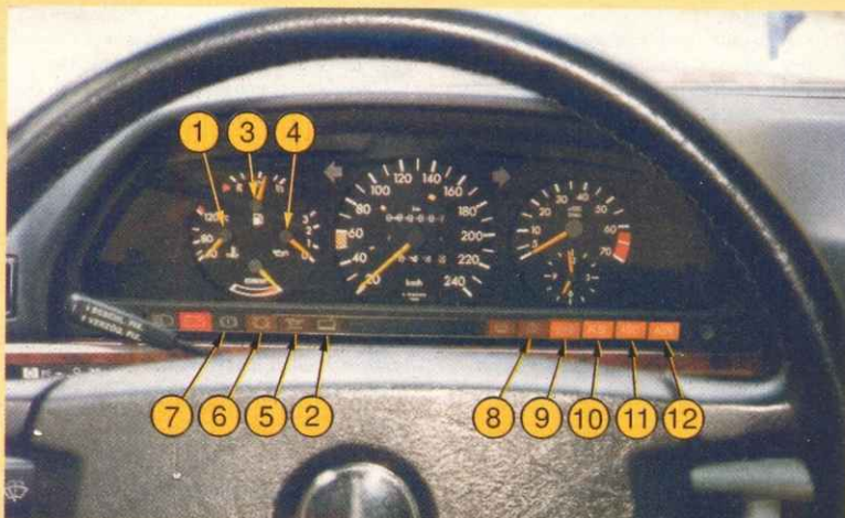
Рис. 1. Схема расположения приборов и контрольных ламп на щитке автомобилей "Мерседес-Бенц" семейства W124 (пояснения в тексте).
