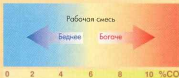
Взаимосвязь цвета пламени в камере сгорания и содержания окиси углерода в выхлопных газах.
