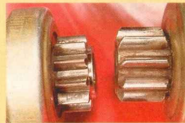
Рис. 3. Износ кромок зубьев шестерни стартера (слева). Справа — новая шестерня.
